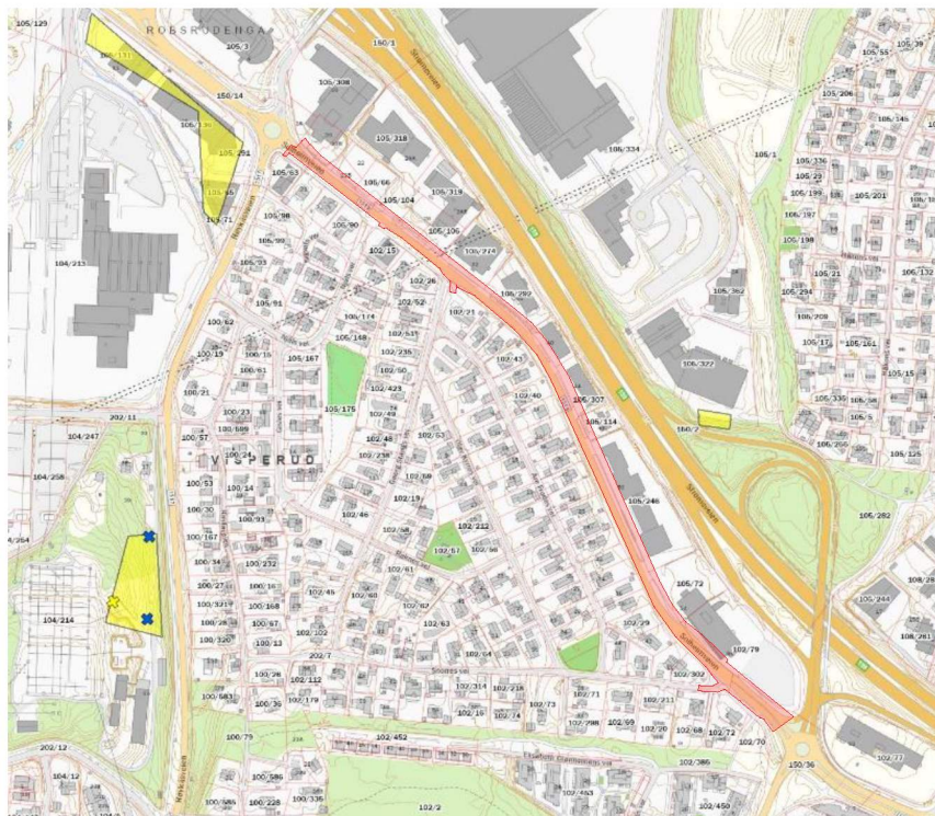
Figur 9: Utsnitt fra Miljødirektoratets grunnforurensningsdatabase [3] viser ingen registrerte lokaliteter langs den aktuelle delen av Solheimveien. Den aktuelle strekninga er markert med rød skravur. Nordvest for tiltaksområdet er en lokalitet registrert. Det er en nedlagt bensinstasjon.
