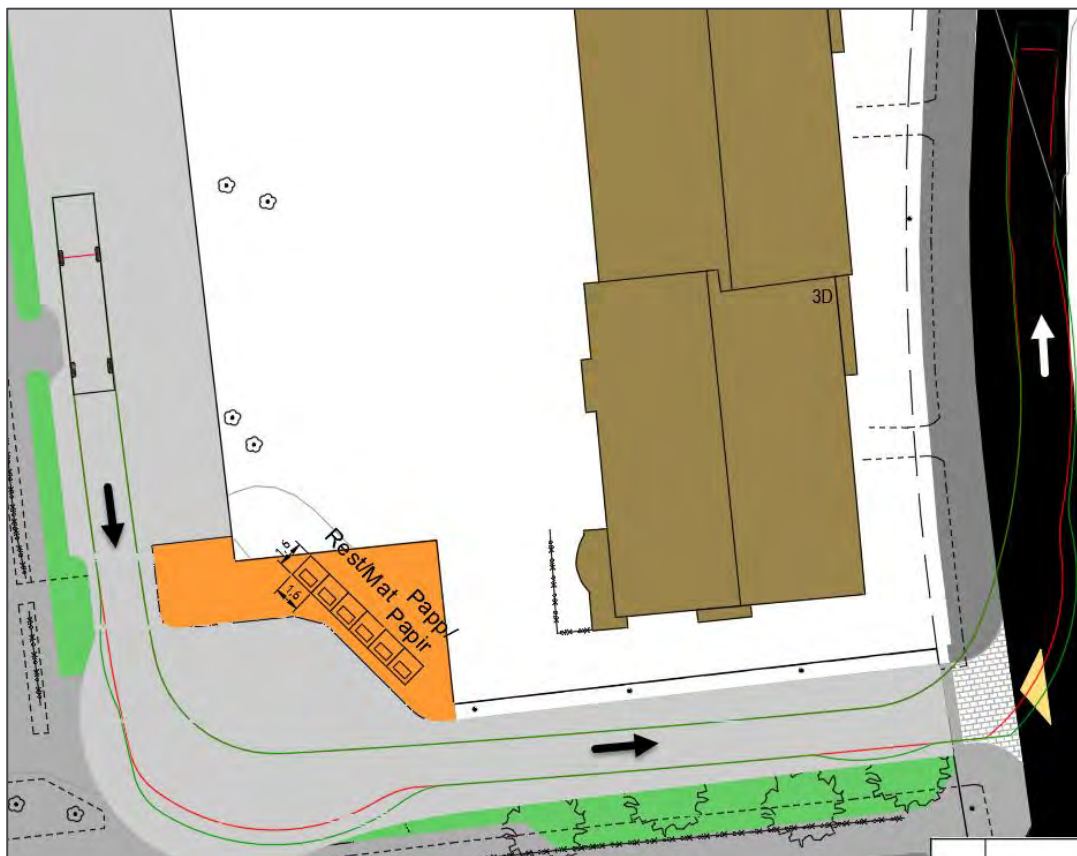
FIGUR 11 Sporingskurver på utkjøringsvei fra oppstillingsplass for renovasjonsbilen.
