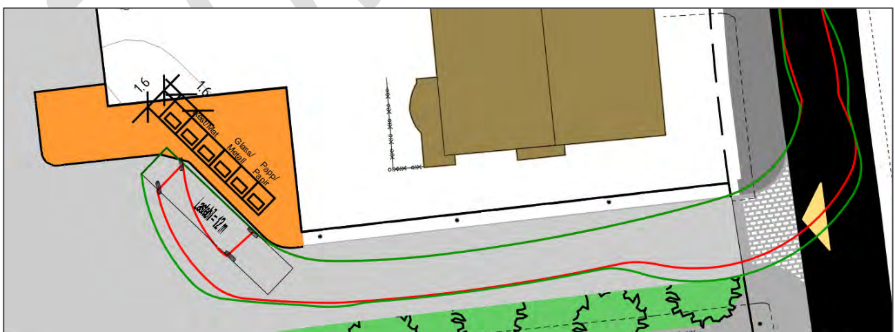
FIGUR 8 Sporingskurver på tilkomstvei til oppstillingsplass for renovasjonsbilen.
