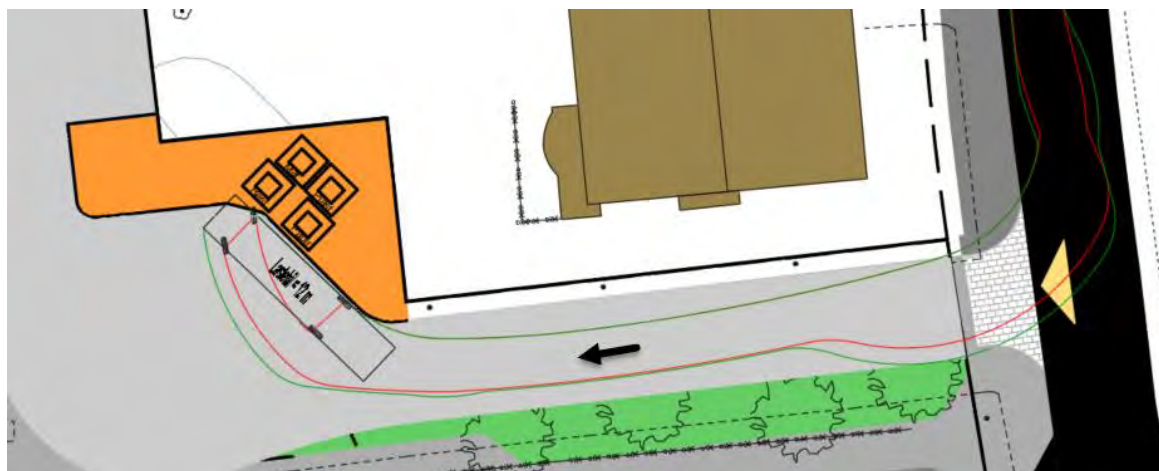
FIGUR 58 Sporingskurver på tilkomstvei til oppstillingsplass for renovasjonsbilen.
