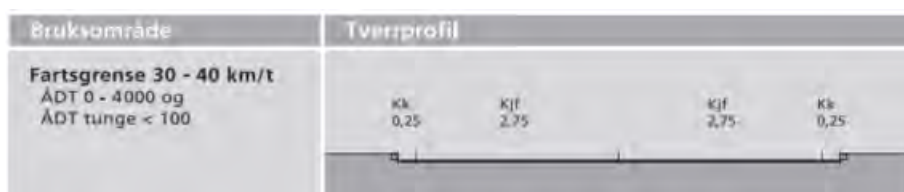
FIGUR 55 Gate med 2 kjørefelt (mål i m). N100 2013
