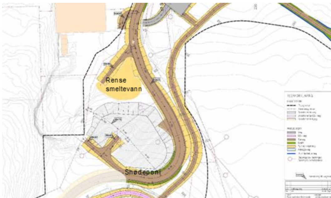
Skisse av plassering av snødeponi, viser mulig adkomst for å legge ut snø og for adkomst til renseløsning.
