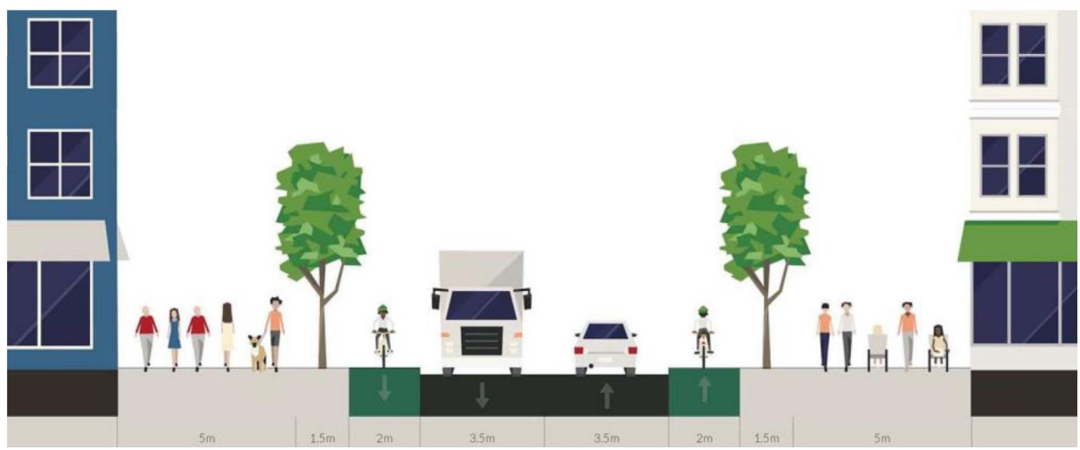
Figur 3.2 Prinsipsnitt av vedtatt utforming av Skårersletta (konsept A) fra konseptvalgutredning for Skårersletta
