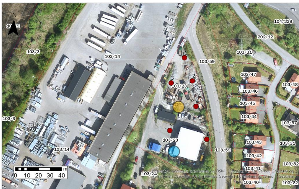
Figur 4: Prøvetakingsplan for miljøteknisk grunnundersøkelse i Gamleveien 3b. Omtrentlig plassering av oljeutskiller er vist med oransje, mens tank for fyringsolje er vist ved blått.
