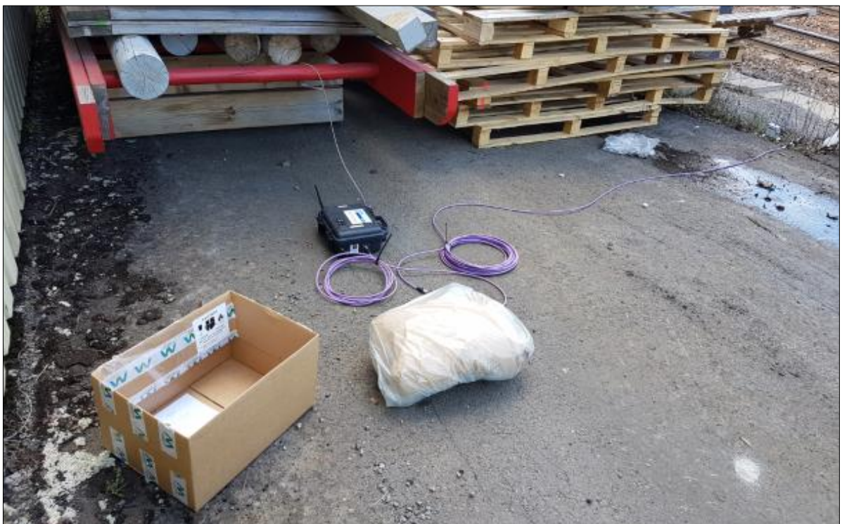
Figur 3: Målekjede 2. Geofoner for komfortverdier og triaksiale målinger belastet med sandsekk.
