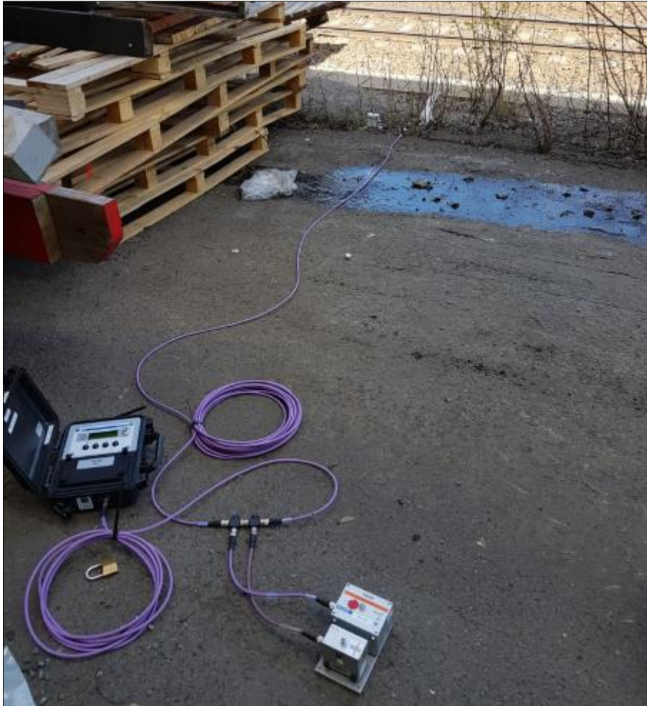
Figur 2: Målekjede 2. Geofoner for komfortverdier og triaksiale målinger nærmest kamera, trigger nærmest spor.
