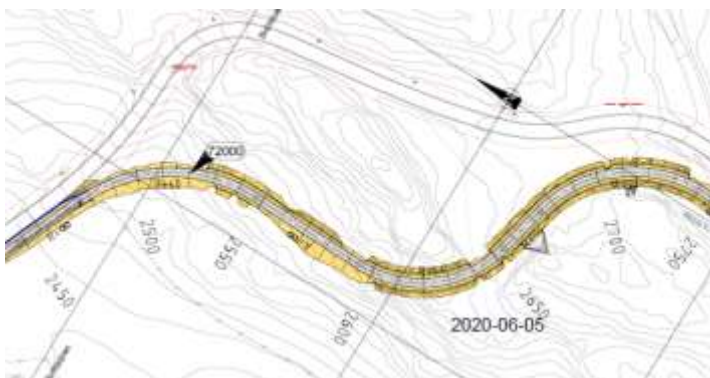
Figur 22: Gang- og sykkelveien fraviker prinsippet om parallellføring med kjøreveien i Bråtabakken.
