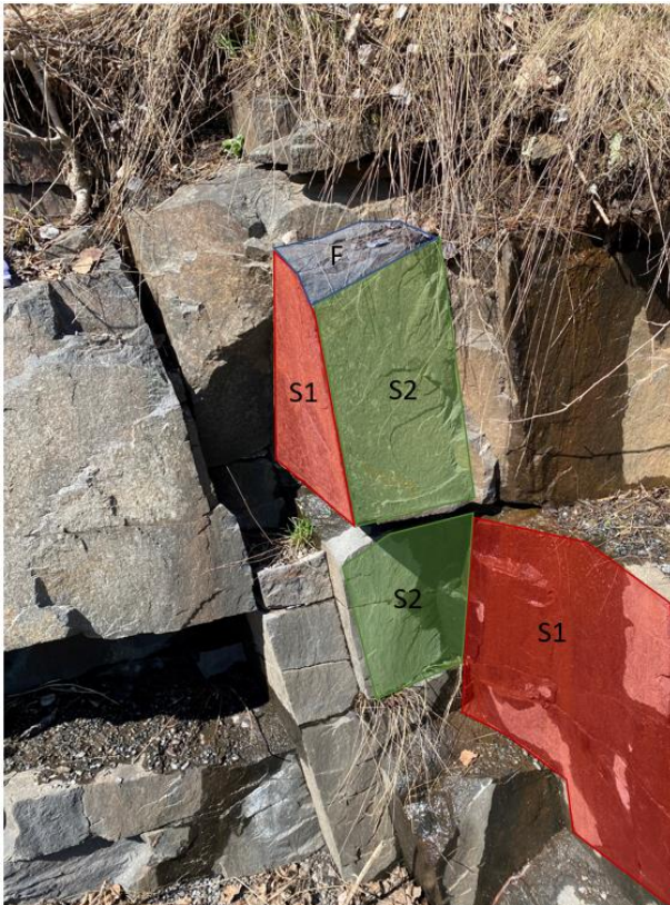
Figur 4: Bildet viser eksisterende bergskjæring langs Nordlifaret. Sprekkesett S1 (rødt), S2 (grønt) og foliasjon F (blått) er markert.
