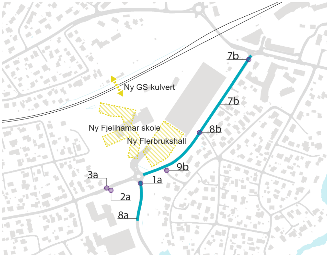
Figur 4 - Oversiktsfigur som viser nummerering av strekninger og kryssingspunkt der det er foreslått trafiksikkerhetstiltak i «midlertidig fase», i østlig del av Marcus Thranes vei og øvre del av Kloppaveien.
