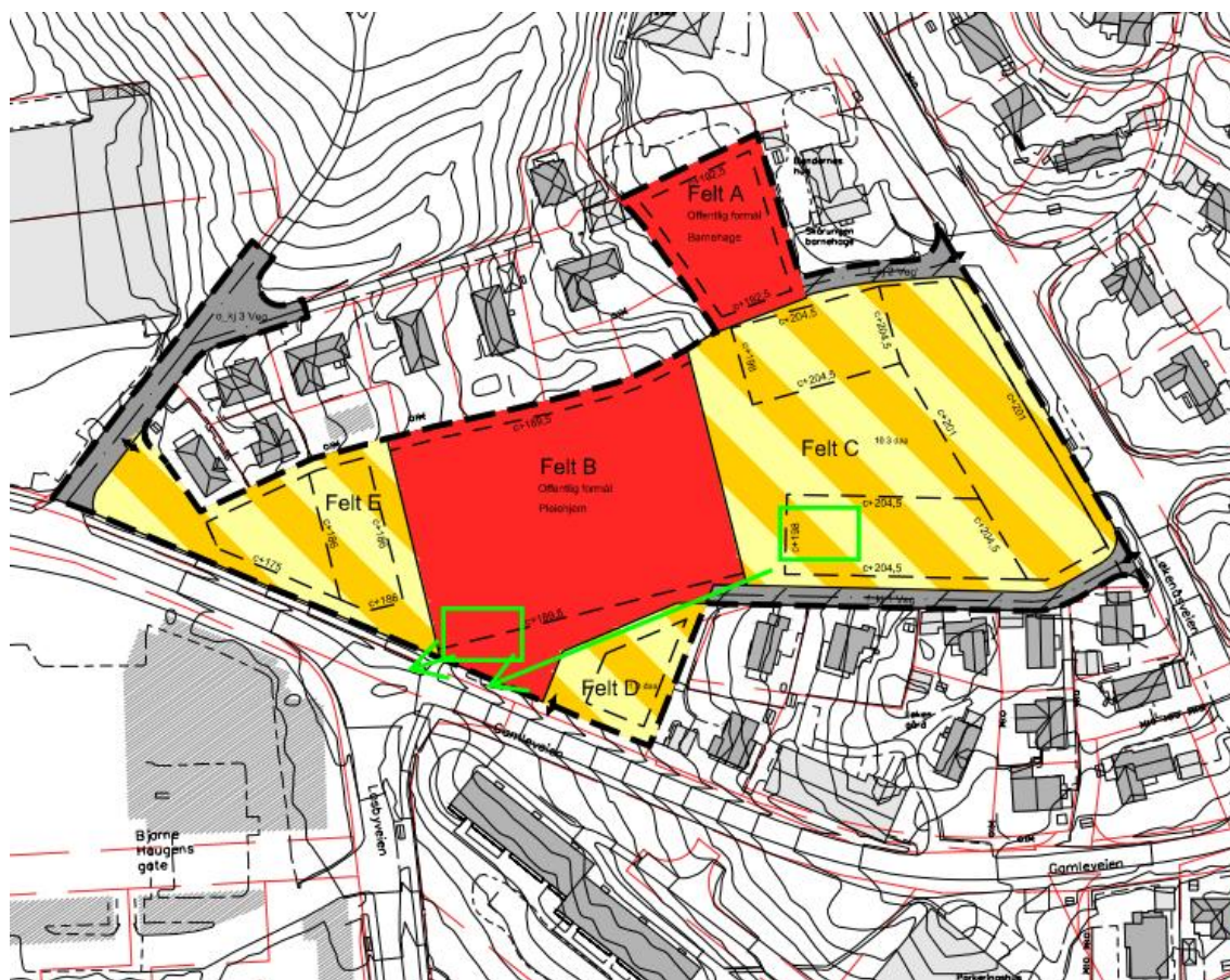
Figur 4b - To fordrøyningsmagasiner for hele planområdet.
