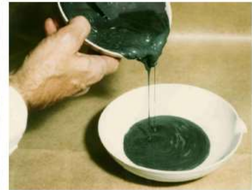
Figur 2.3 Illustrasjon av forskjellen i kvikkleiras egenskaper før og etter en overbelastning. Før brudd kan kvikkleira bære relativt stor last og etter brudd blir leira flytende (Foto: NGI).
