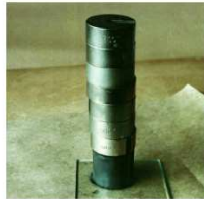
Figur 2.3 Illustrasjon av forskjellen i kvikkleiras egenskaper før og etter en overbelastning. Før brudd kan kvikkleira bære relativt stor last og etter brudd blir leira flytende (Foto: NGI).
