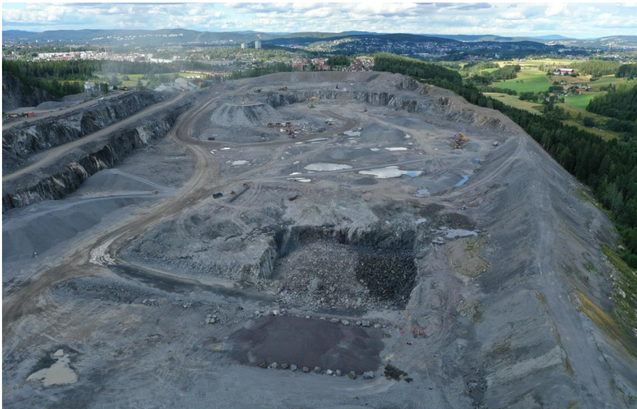
Figur 4: Dagens situasjon i bruddet, omkranset av voller. Synk etablert på kt. +175 (nederst på bildet)
