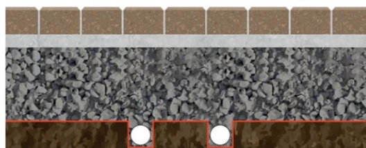
System C – Ingen infiltrasjon til grunnen.
