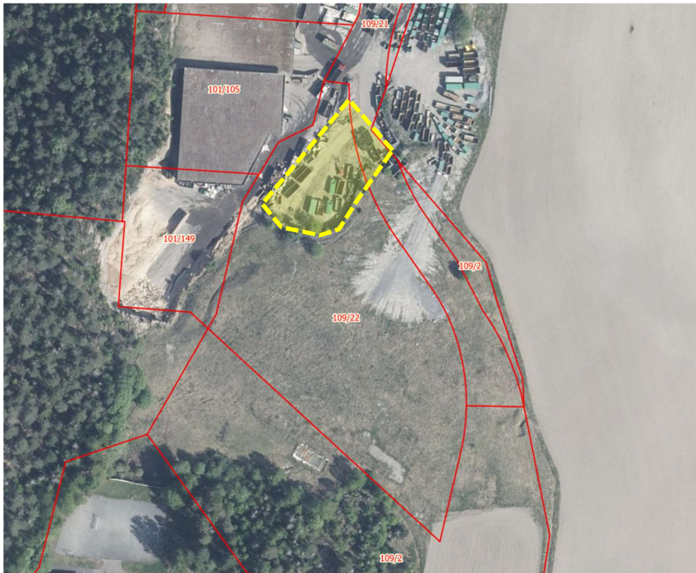
Figur 25. Areal som avsettes til renseløsning er vist med gul skravur, tilsvarer ca. 850 m 2 , men reelt areal til renseløsningene er mindre enn dette. Avrenning til renseløsning må fanges opp ved eksempelvis etablerte grøfter ved selve snødeponiet og ledes kontrollert til renseløsning.
