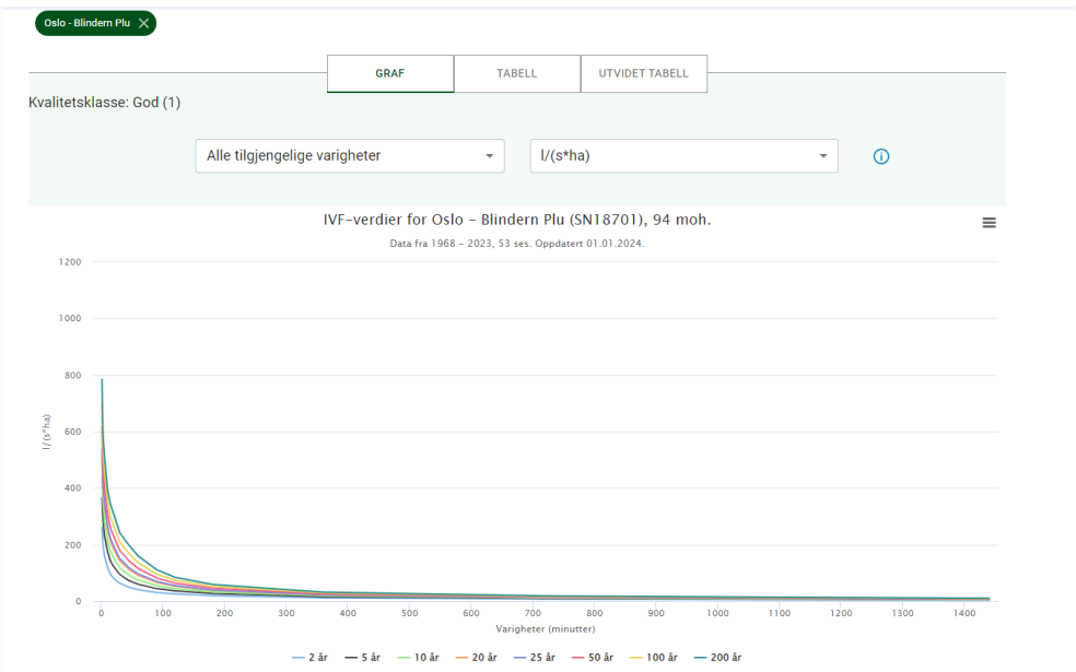
Figur 2: IVF kurve for Blinder målestasjon. Kilde: Klimaservicesenter
