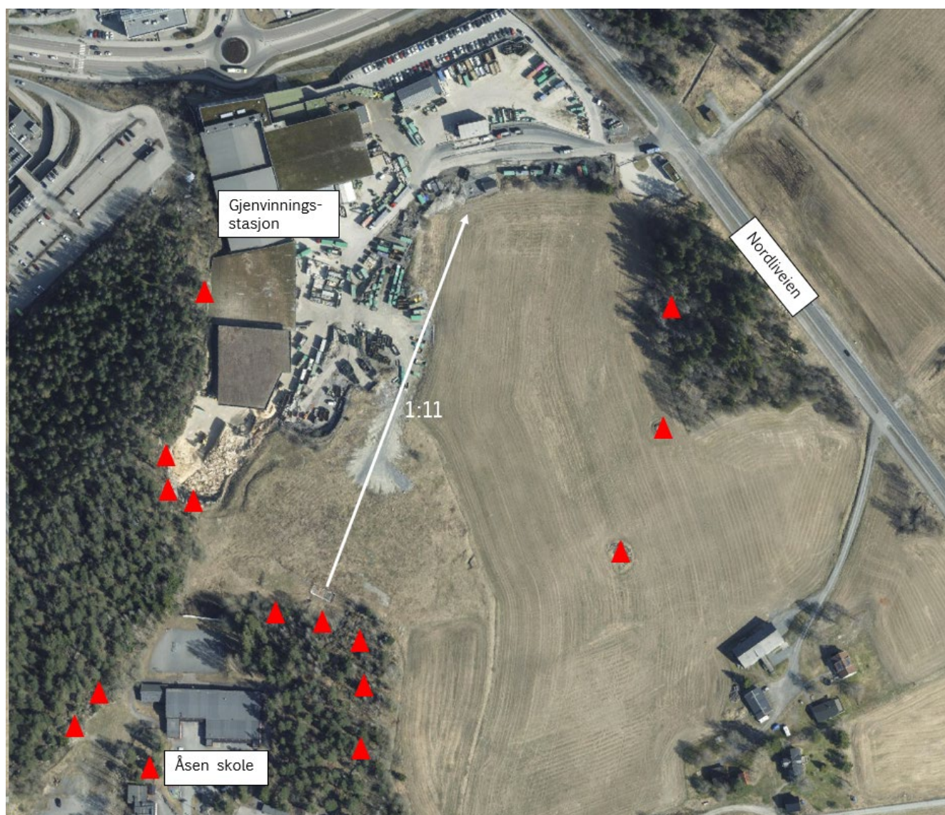
Figur 3 Flyfoto over aktuelt område med fjell i dagen og skråningshelning.
