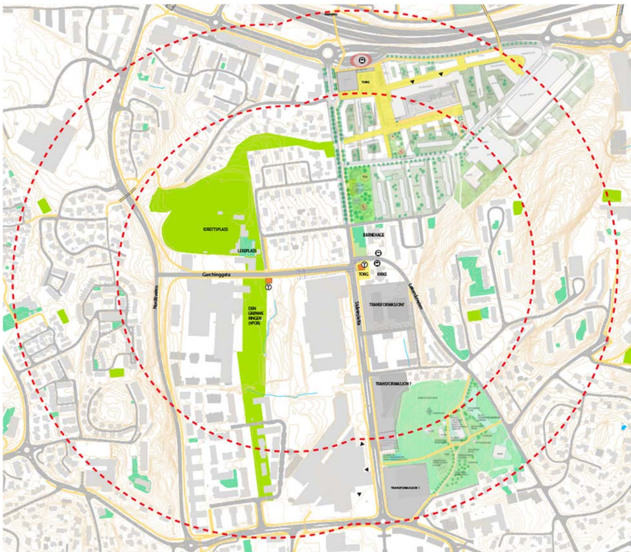
Figur 4-45: Alternativ A, stasjon på Skårersletta. De røde sirklene viser 400 meter og 600 meter fra oppgangene. 400 meter er ca. 5 minutters gange. Stasjonen har nærhet til mange boliger, men det vil være vanskelig å få til et godt kollektivknutepunkt med dette alternativet, da stasjonen ligger for langt fra bussterminalen til å få et godt byttepunkt. Stasjonen ligger også for langt unna de store utviklingsområdene på Skårer sør til å oppleves som et attraktivt kollektivtilbud for beboerne her. Tegningene fra VPOR Lørenskog er brukt som underlag for skissen.
