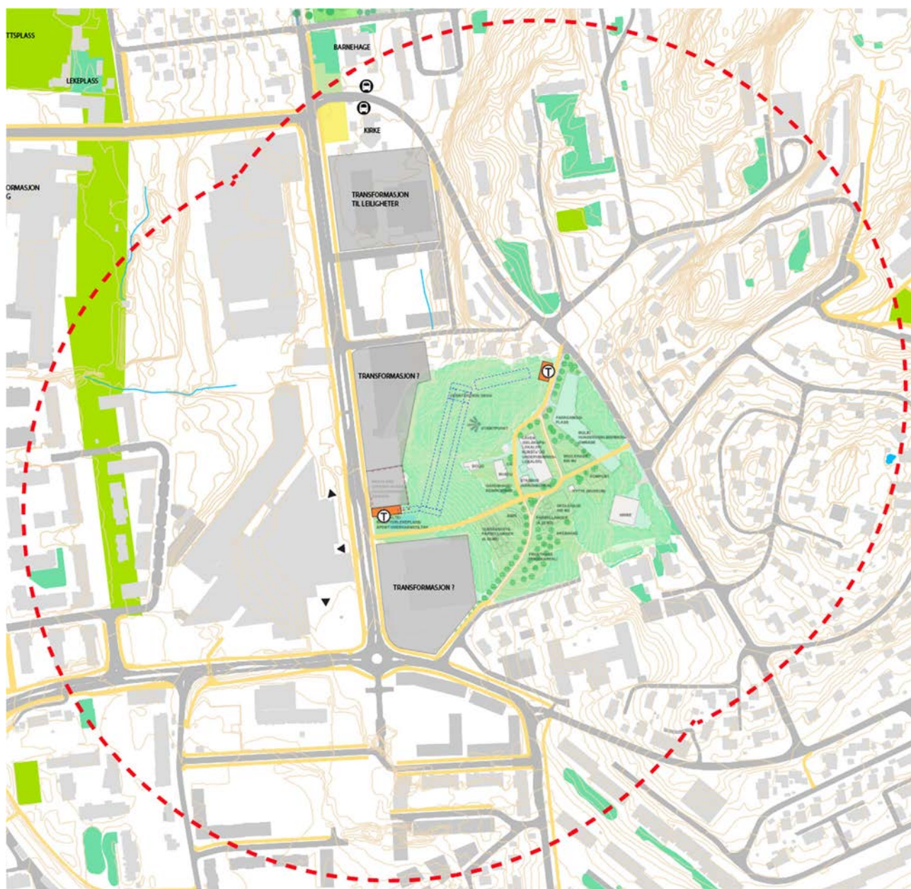
Figur 4-46: Alternativ B, stasjon på Skårer. Den røde, stiplede linjen viser 400 meter fra oppgangene, som tilsvarer 5 minutters gange og anses som akseptabel avstand til stasjonen. Tegningene fra VPOR Lørenskog er brukt som underlag for skissen.
