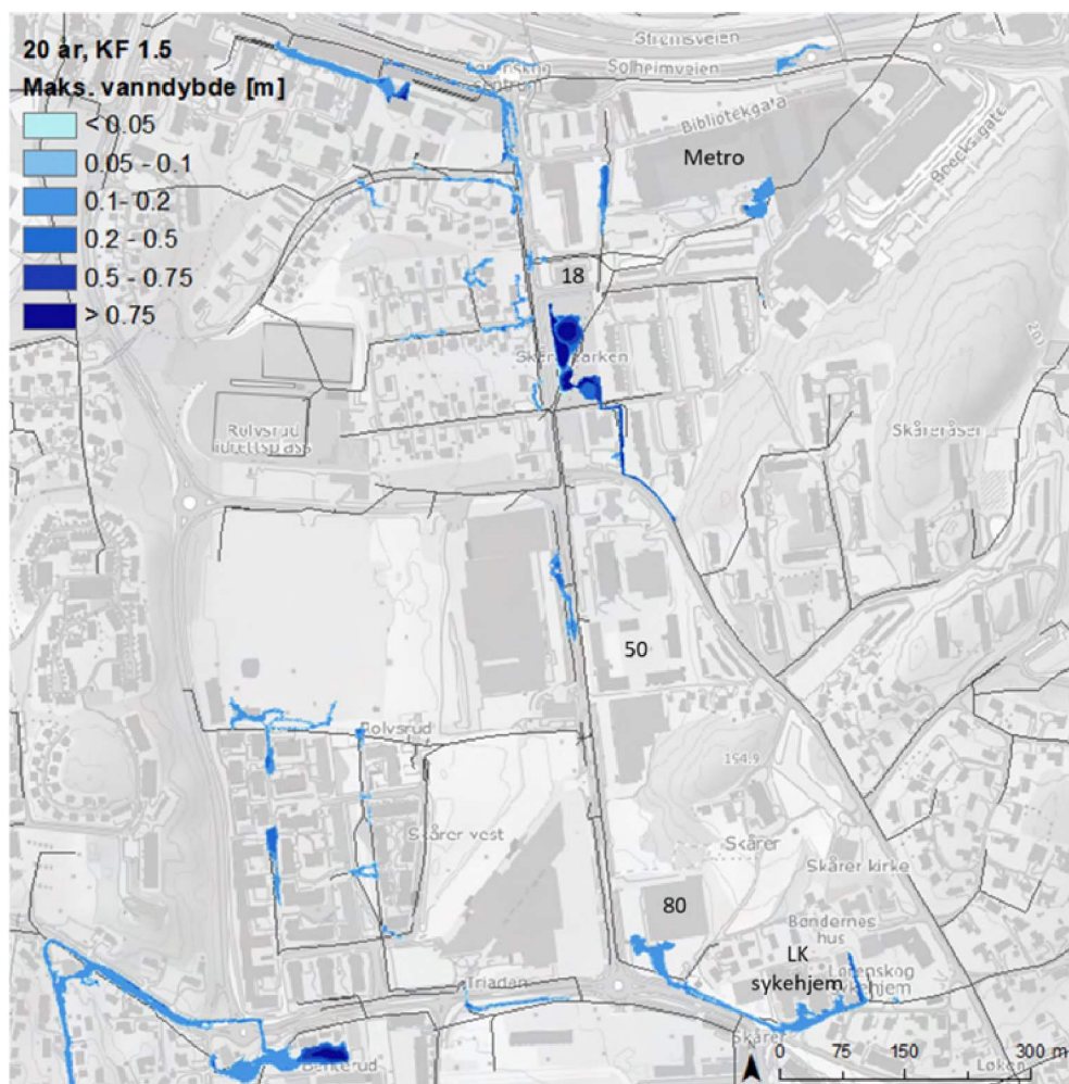
Figur 10 - Resultater hydraulisk modellering for 20 års regn. Maksimal vanddybde på terreng
