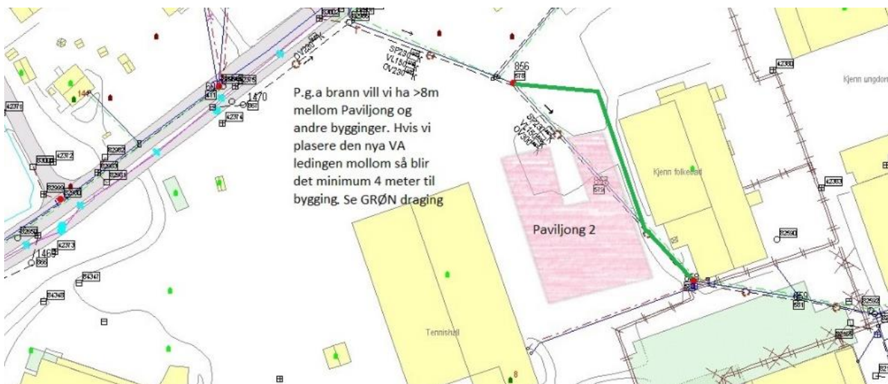
Figur 17 - Fornyelse og omplassering av VA-ledning
